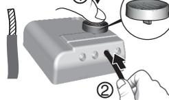
Drücken Sie mit dem Werkzeug oder einem 2,5mm-Schraubenzieher in den Schlitz der Klemme und schieben Sie den Draht ein.
