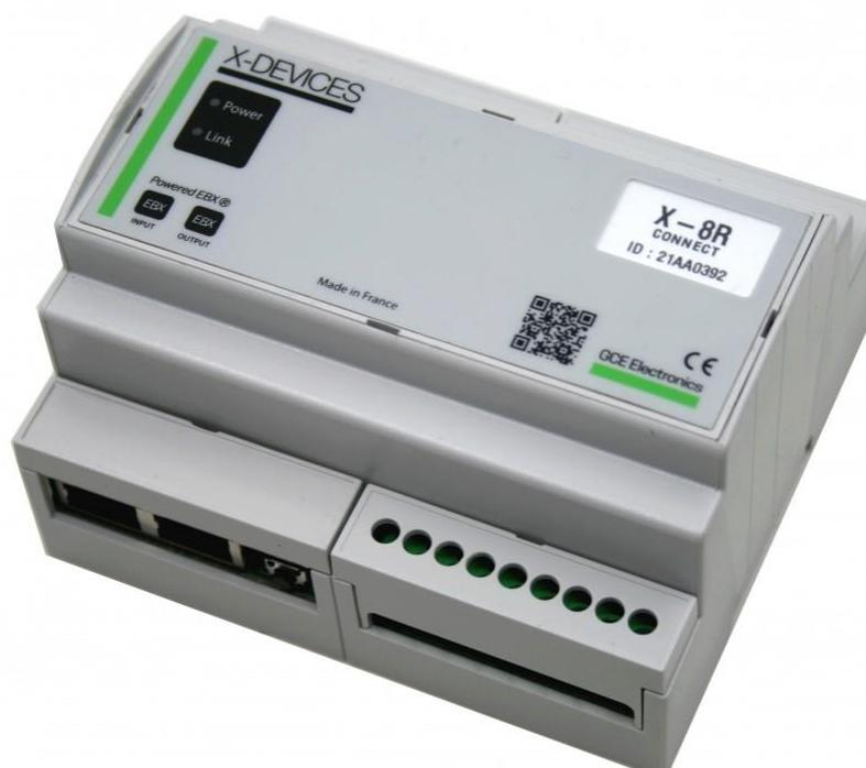
L'extension X-8R Connect permet d'intégrer 8 sorties relais supplémentaires dans l'univers d'une l'IPX800 V4 ou V5.
