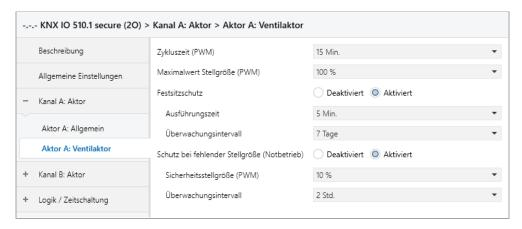
Um z.B. eine Heizung zu steuern reicht kein binärer Wert, da die Heizung nicht nur ein- oder ausgeschaltet, sondern eine bestimmte Stellgröße eingestellt werden soll. Dies geschieht mittels einer langsamen Pulsweitenmodulation (PWM).
