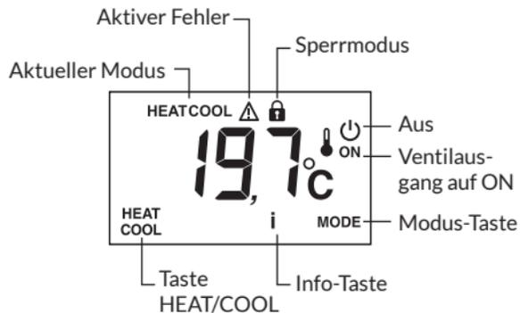
**Taste HEAT/COOL:** Wird im Modus OFF angezeigt, bei Temperaturreglern vom Typ „Master“ und je nach Konfiguration der Installation. Drücken Sie 3 Sekunden auf die Taste, um von einem Modus in den anderen umzuschalten.
